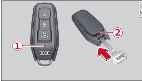
图 12 汽车钥匙: 拆卸电池封盖
