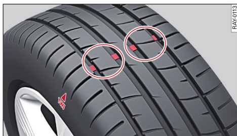
图 126 轮胎花纹：磨损指示
