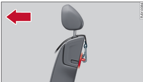
图 47 后座椅靠背：将上部固定带钩在 Top Tether 上部固定带的固定卡座上
