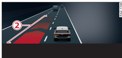
图 77 组合仪表：侧向辅助警告功能显示
