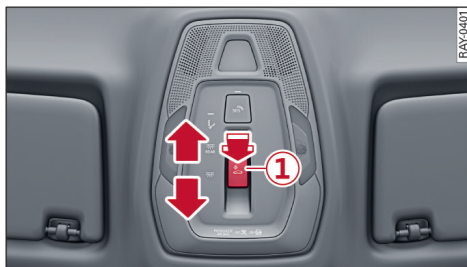
图 27 天花板：可调节透明度的全景玻璃天窗的按钮
