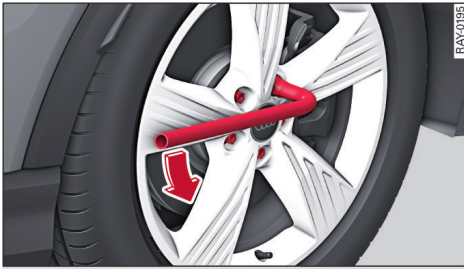
图 133 车轮：松开车轮螺栓
