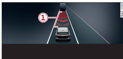
图 75 组合仪表：车周环境显示内的车距警告
