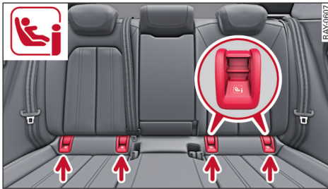
图 46 后座长椅：下部 ISOFIX 固定座
