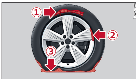
图 128 轮胎：无法修理的轮胎损坏
