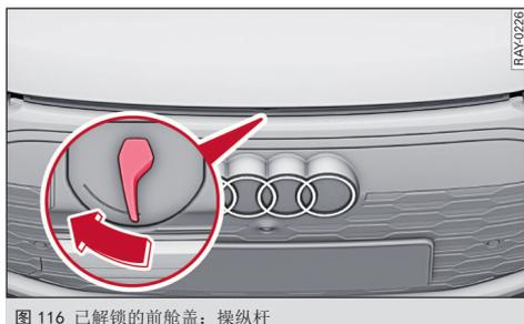
图 116 已解锁的前舱盖：操纵杆
