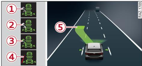
图 85 组合仪表：车道变换辅助显示
