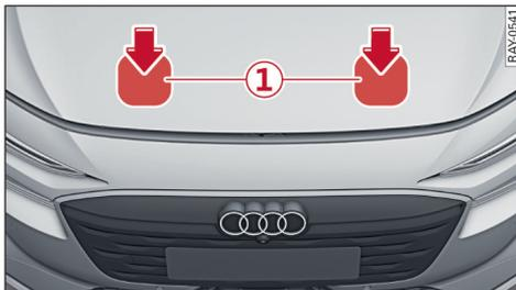
图 117 给前舱盖解锁：① 关闭压力点
