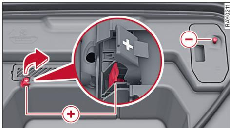
图 134 前舱：辅助启动电缆或充电装置的接口
