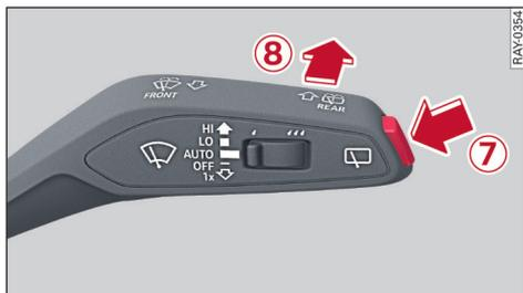
图 29 车窗雨刮器操纵杆：后雨刮器
