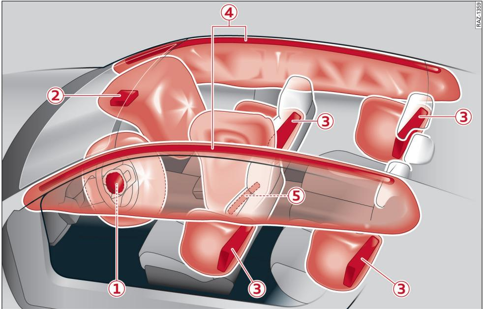
图 45 安全气囊概览图（释放部位/触发了的安全气囊）
