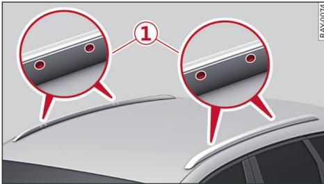
图 60 车顶行李架饰条：固定点
