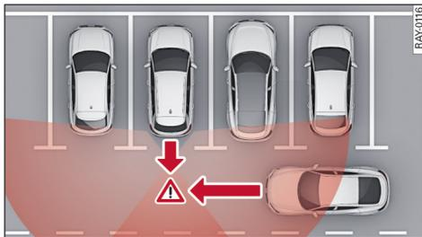
图 105 装有后方交通穿行辅助系统时的感应器探测范围
