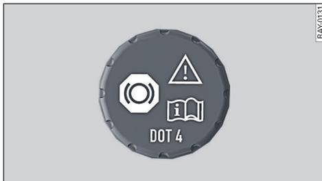
图 121 前舱：制动液储液罐盖
