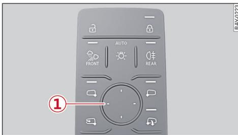
图 25 驾驶员车门：车外后视镜的操作区
