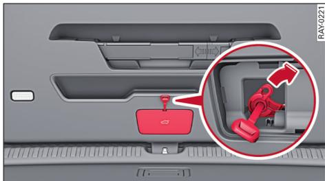
图 18 行李厢盖内部：应急解锁操作口
