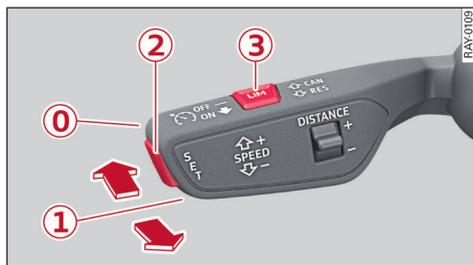
图 94 操纵杆：操作导航辅助驾驶系统
