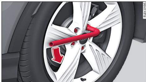
图 132 车轮：松开车轮螺栓
