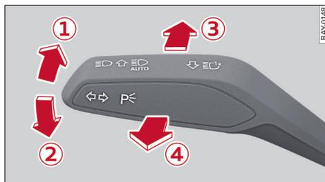
图 21 转向信号灯和远光灯的操纵杆：打开/关闭车灯功能
