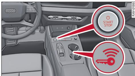
图 63 中控台：开启驱动系统
