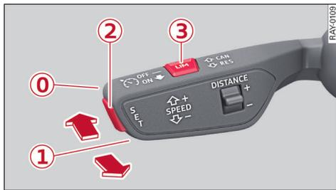
图 90 操纵杆：操作自适应巡航控制系统
