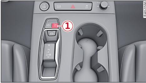
图 75 中控台：泊车转向辅助系统按钮
