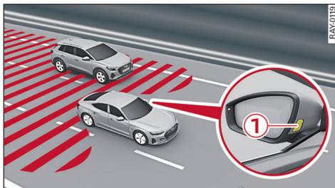
图 77 驾驶情形和外后视镜上的显示
