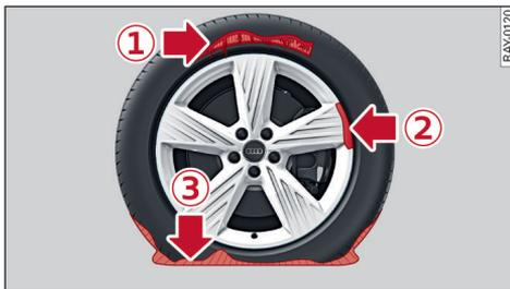
图 127 轮胎：无法修理的轮胎损坏
