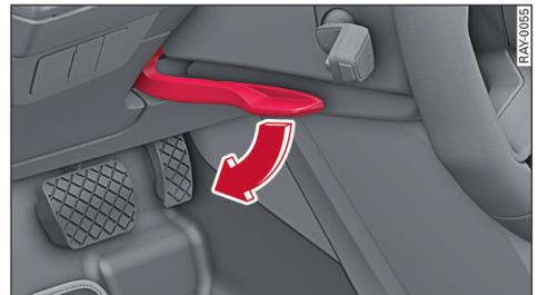
图 34 转向柱：调节方向盘位置的操纵杆
