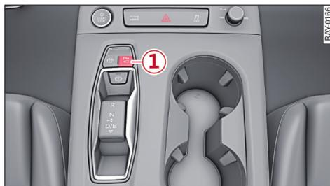
图 101 中控台：泊车转向辅助系统按钮
