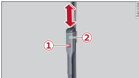
图 30 前挡风玻璃雨刮：更换雨刮片
