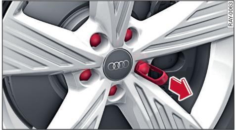
图 130 车轮：车轮螺栓及封盖
