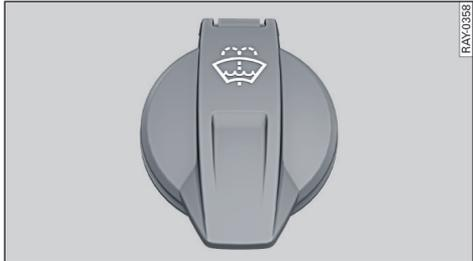
图 124 前舱：车窗玻璃清洗液储液罐
