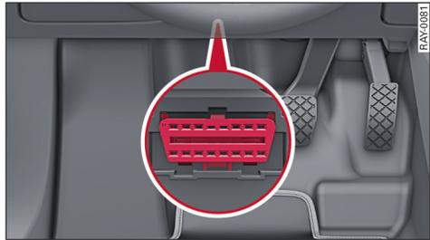
图 145 驾驶员侧的脚舱：诊断系统的接口
