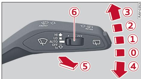
图 28 雨刮操纵杆、车窗雨刮器
