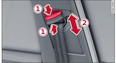
图 44 前座椅安全带高度调整机构 - 导向件
