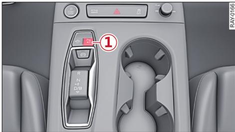
图 103 中控台：泊车转向辅助系统按钮
