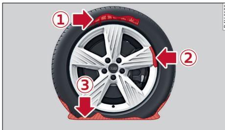
图 129 轮胎：无法修理的轮胎损坏
