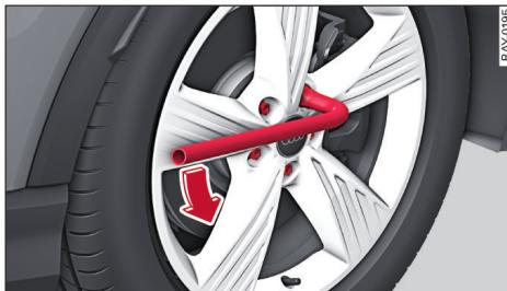
图 134 车轮：松开车轮螺栓
