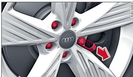
图 132 车轮: 车轮螺栓及封盖
