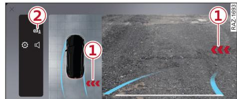
图 108 中央显示屏：后方交通穿行辅助系统的显示
