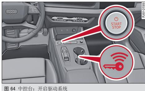
图 64 中控台：开启驱动系统
