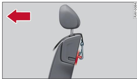
图 49 后座椅靠背: 将上部固定带钩在 Top Tether 上部固定带的固定卡座上
