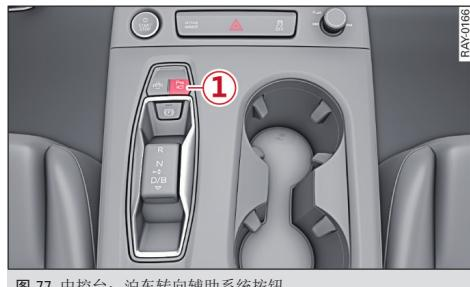
图 77 中控台：泊车转向辅助系统按钮
