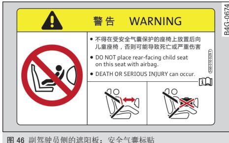
图 46 副驾驶员侧的遮阳板：安全气囊标贴
