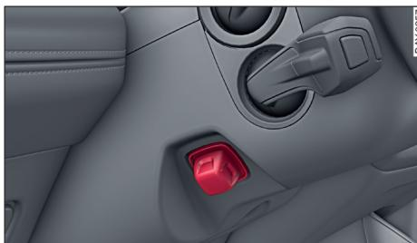
图 35 转向柱：调节方向盘位置的开关
