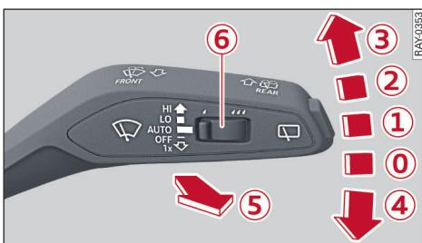
图 28 车窗雨刮器操纵杆：前雨刮器
