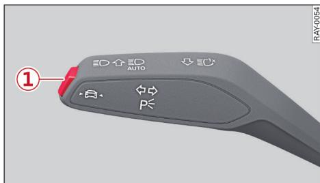
图 83 操纵杆：车道偏离警告和车道引导功能按钮
