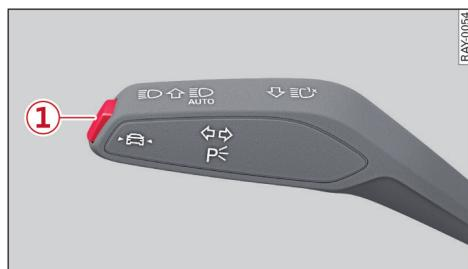
图 85 操纵杆：车道引导功能和车道偏离警告功能按钮
