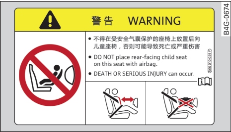
图 46 副驾驶侧的遮阳板：安全气囊标识
