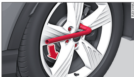
图 132 车轮：松开车轮螺栓
