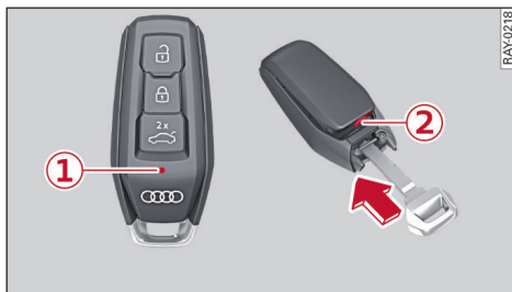
图 12 汽车钥匙：拆卸电池封盖
