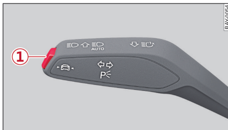
图 81 转向灯操纵杆：车道偏离警告和车道引导功能按钮
