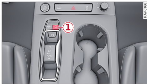
图 103 中控台：泊车转向辅助系统按钮
