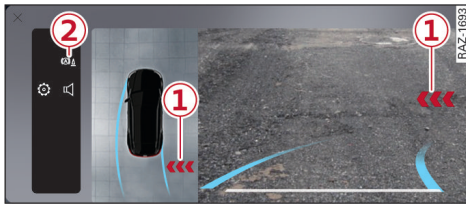
图 106 中央显示屏：后方交通穿行辅助系统的显示
