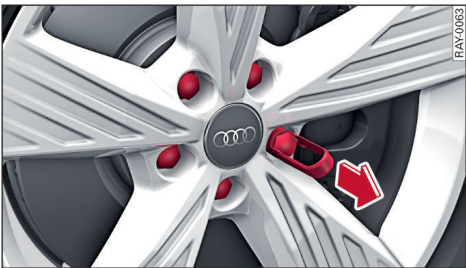
图 130 车轮：车轮螺栓及封盖
