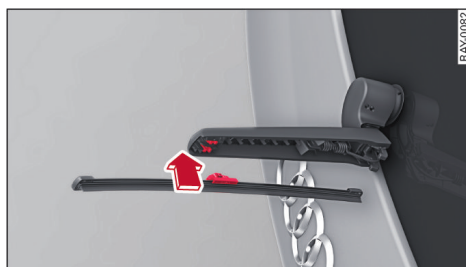
图 31 后窗玻璃雨刮器：固定雨刮片
