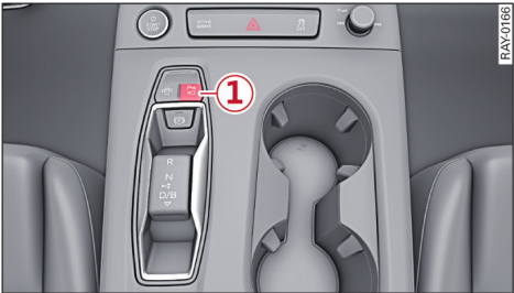
图 101 中控台：泊车转向辅助系统按钮
