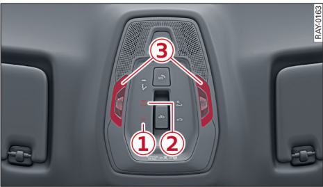
图 23 天花板：内照明灯
