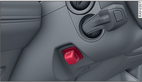
图 35 转向柱：调节方向盘位置的开关
