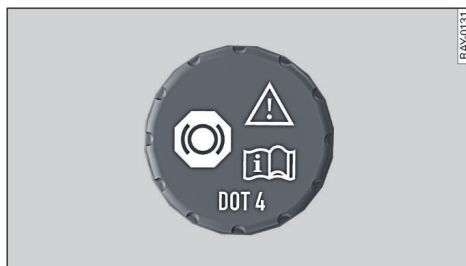
图 121 前舱：制动液储液罐盖
