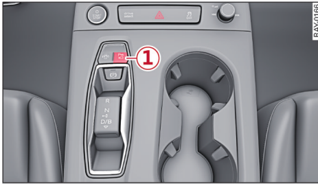
图 75 中控台：泊车转向辅助系统按钮
