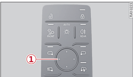
图 25 驾驶员车门：车外后视镜的操作区
