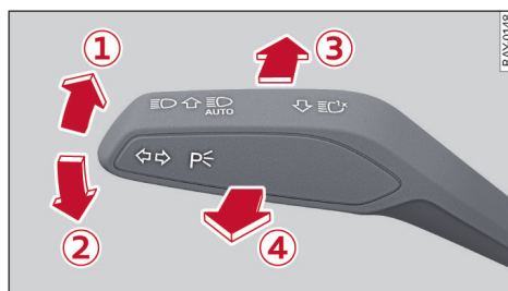
图 21 转向信号灯和远光灯的操纵杆：打开/关闭车灯功能
