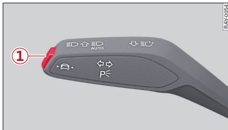
图 83 转向灯操纵杆：车道引导功能和车道偏离警告功能按钮
