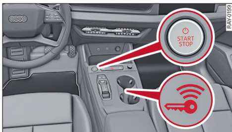
图 63 中控台：开启驱动系统
