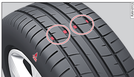
图 125 轮胎花纹：磨损指示
