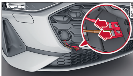
图 7 前保险杠：封盖及卡在里面的 12 伏电接口
