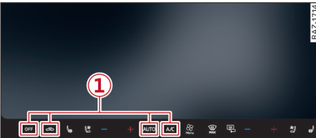
图 61 中央显示屏：空调装置操作栏
